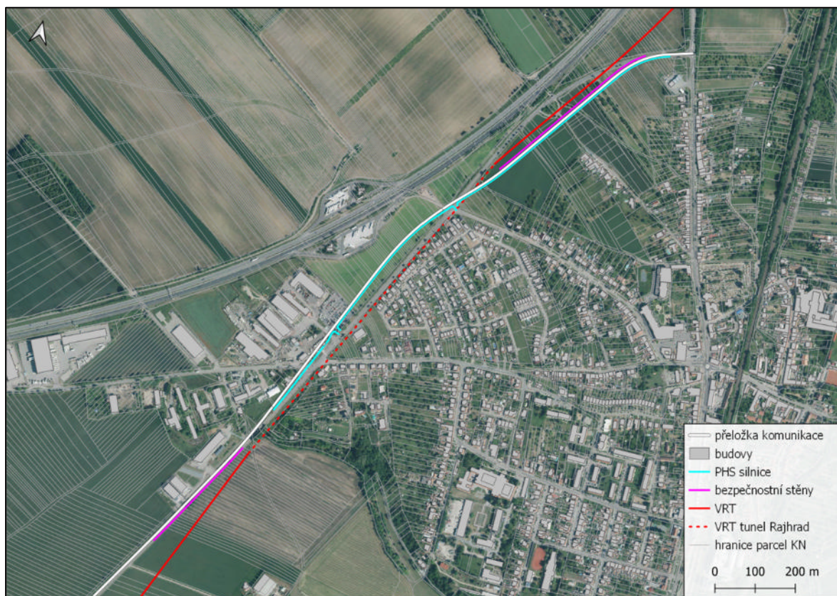
Obrázek 23 Umístění bezpečnostních stěn podél VRT/přeložky komunikace ( www.mapy.cz )
